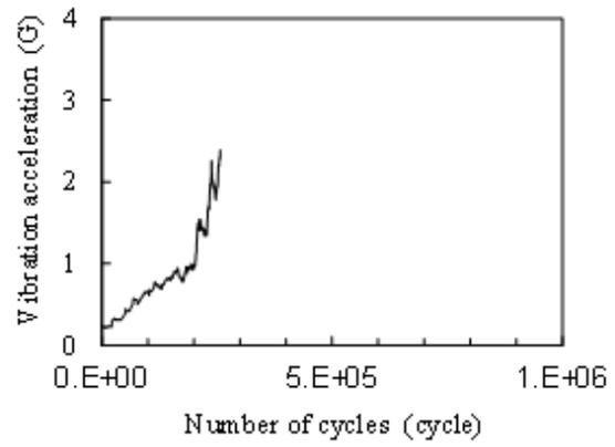
(d) Vibration acceleration of testing machine
