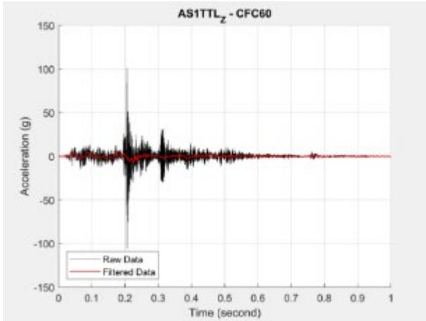
**Figure B37. AS1TTL\_Z Accelerometer Data**
