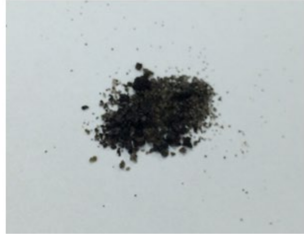
(b) Powder of the slag layer
