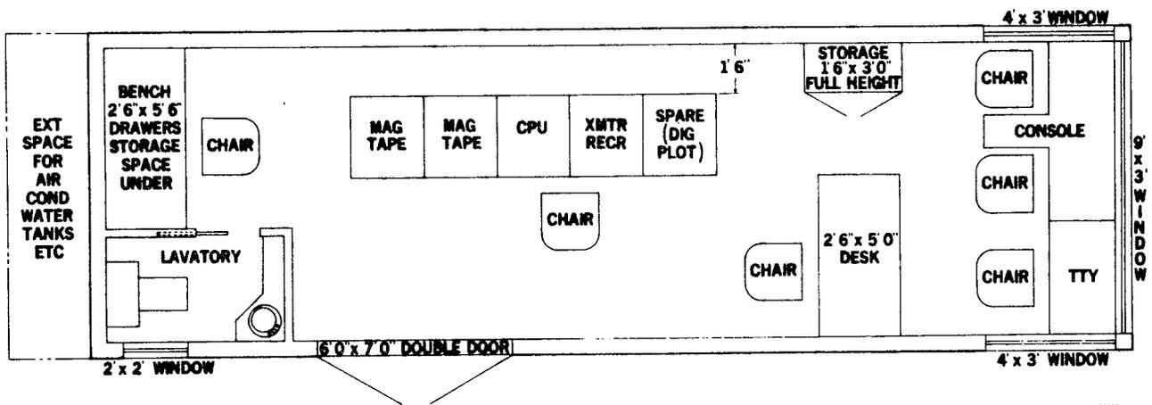
FIG. 17 GROUND STATION TRAILER LAYOUT
