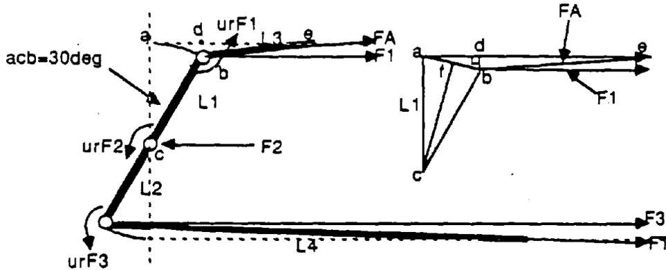
If the lever angle = 30 deg, then angle CAB = ABD = 75 deg, and since angle ABD = 90 deg, angle DAB = 15 deg.
