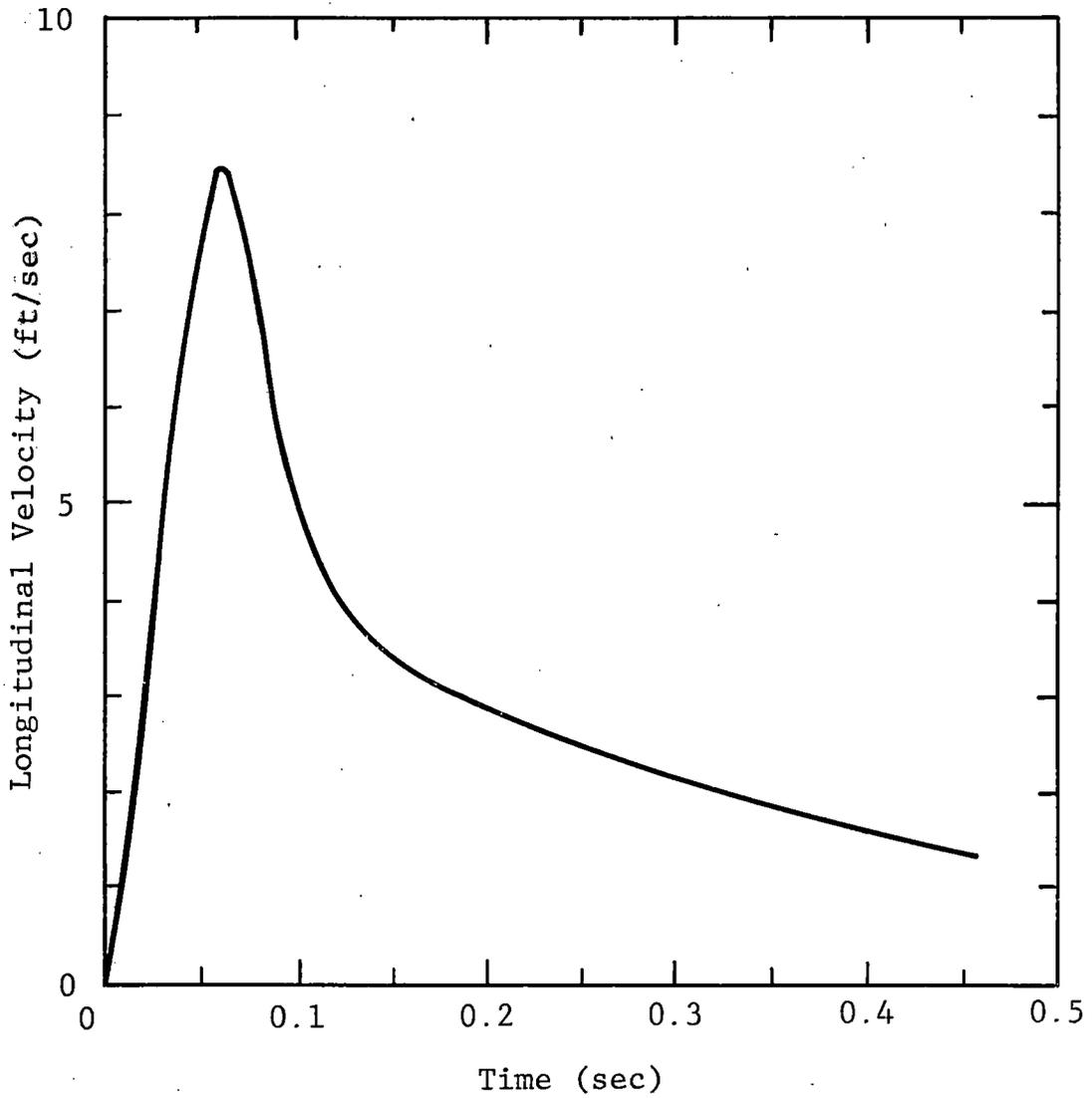
Figure 25 LONGITUDINAL VELOCITY OF STRUCK CAR
