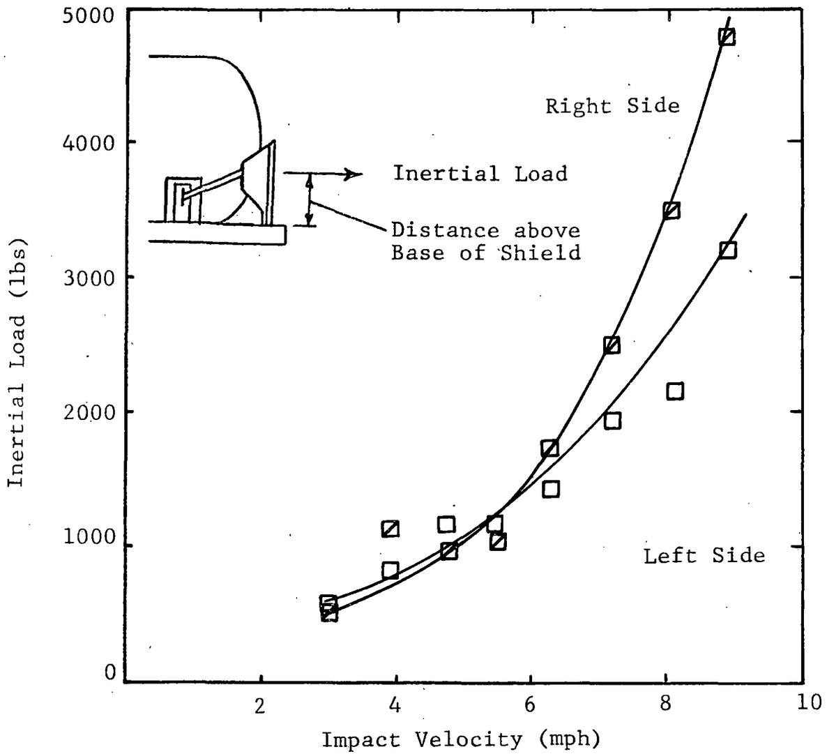
Figure 16 MAXIMUM LONGITUDINAL INERTIAL LOAD ACTING THROUGH TUBE SHIELD SUPPORTS
