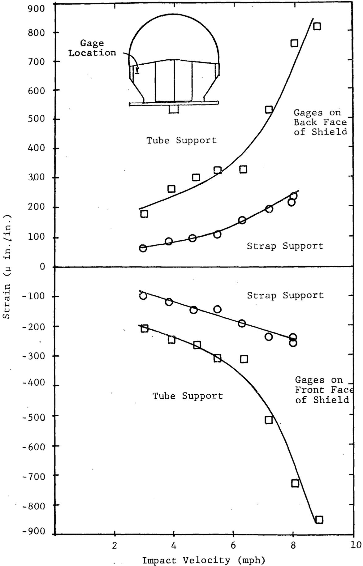
Figure 13 MAXIMUM HORIZONTAL STRAINS MEASURED ON LEFT SIDE OF SHIELD
