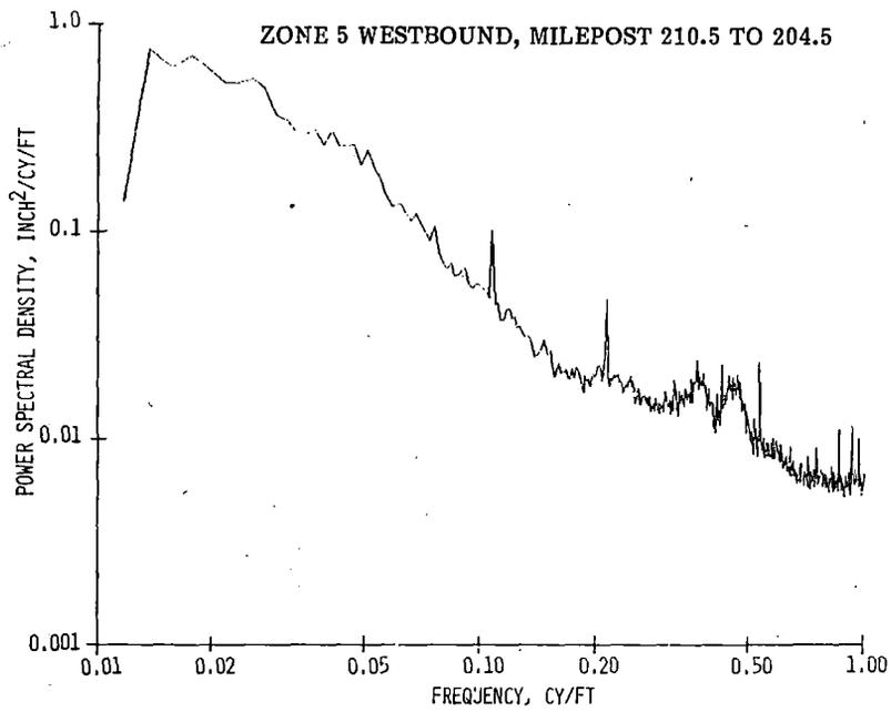
FIGURE B-14. POWER SPECTRAL DENSITY - ZONE 5, RIGHT PROFILE
