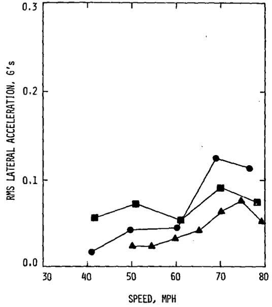
FIGURE 5.3.1-14 RMS LATERAL ACCELERATION AT SILL LEVEL VERSUS SPEED - RIGID TRUCKS/LOADED CARS
