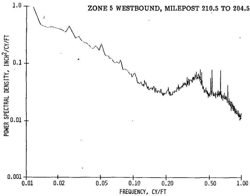
**FIGURE B-12. POWER SPECTRAL DENSITY - ZONE 5, GAUGE**
