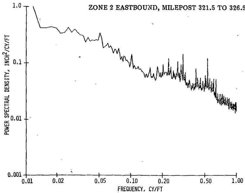
FIGURE B-4. POWER SPECTRAL DENSITY - ZONE 2, GAUGE
