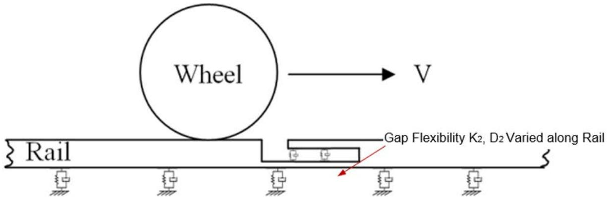
**Figure 25. Flexible Gap Rail Model**
