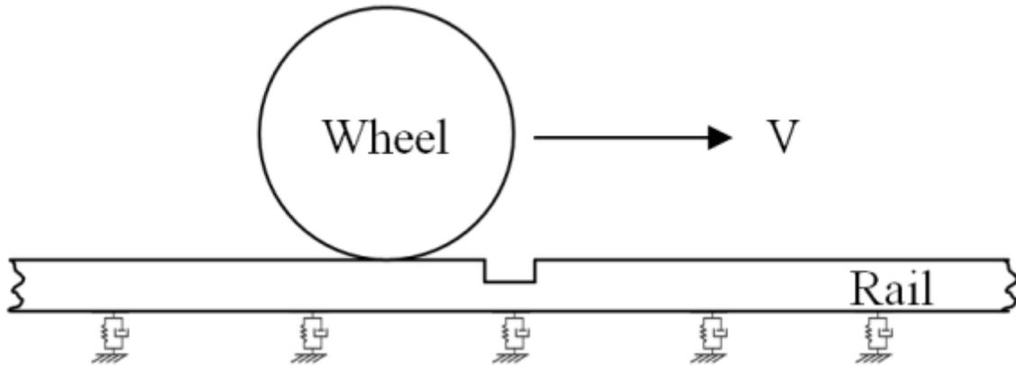
**Figure 24. Rigid Gap Rail Model**
